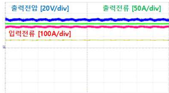
그림 5 DC/DC 컨버터 입출력 전압, 전류 파형 Fig. 5 DC/DC Converter Input/Output Sensing Voltage, Current Waveform
